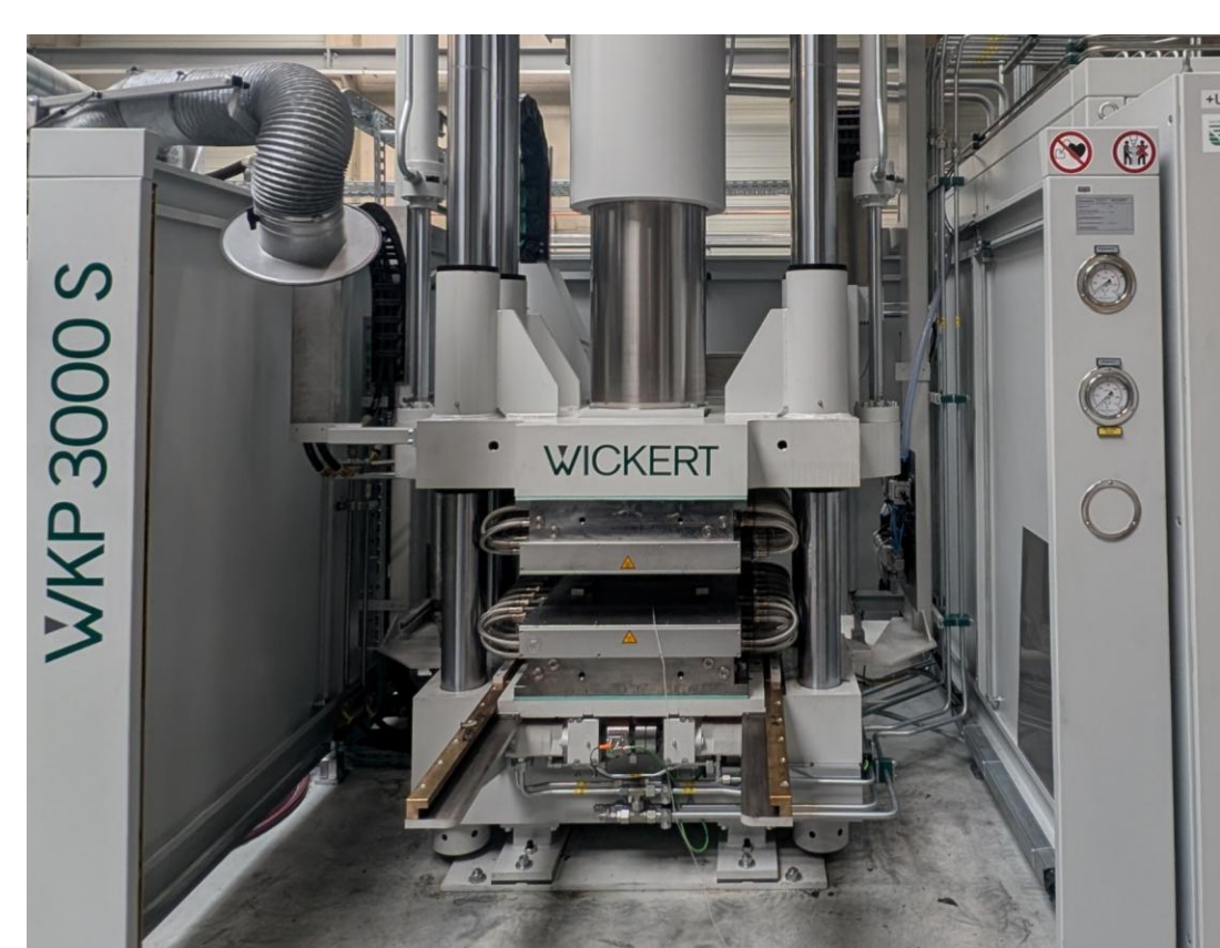
Induktiv beheizte Presse Wickert WKP 3000S HT
